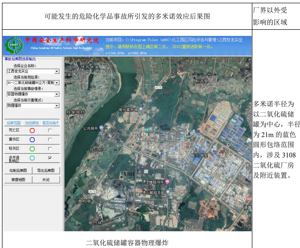
根据多米诺分析可知，该项目产生多米诺半径最大的为二氧化硫储罐容器物理爆炸，二氧化硫储罐安全附件失效，液化的二氧化硫发生汽化，二氧化硫储罐可能发生容器物理爆炸，多米诺半径为以二氧化硫储罐为中心，半径为21m的蓝色圆形包络范围内，涉及3108二氧化硫厂房及附近装置。企业应加强压力容器及液化物料的安全管理。
