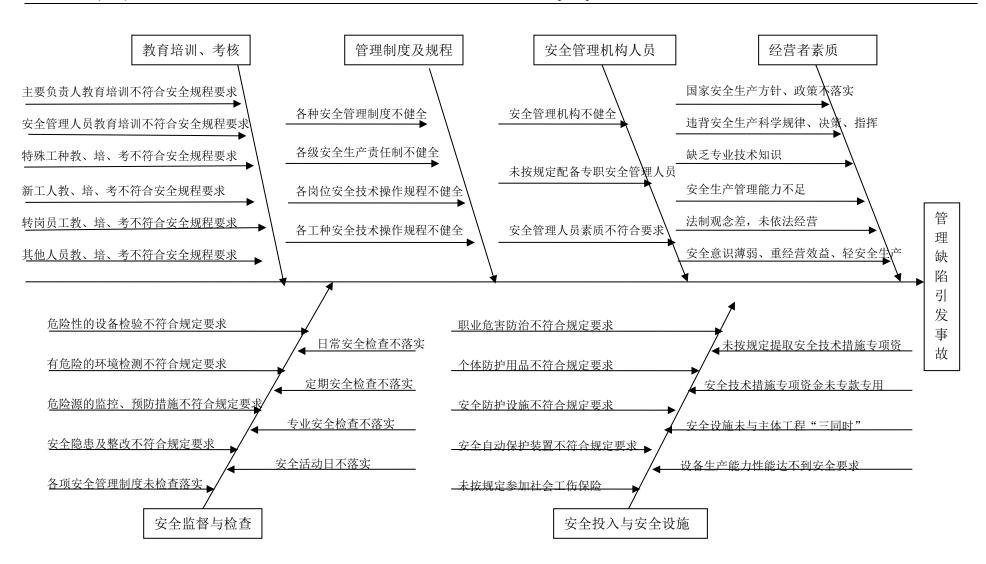
图 5.4-1 安全管理缺陷引发事故的因果关系图
